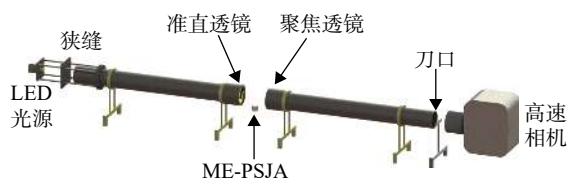
图 3 高速纹影系统示意图
