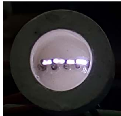
图 5 多电极合成射流激励器放电图
