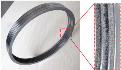
(b) 实验件实物图 图 6 各级差异化多级刷式密封实验件 Fig. 6 Different levels of multistage brush seal experimental piece
