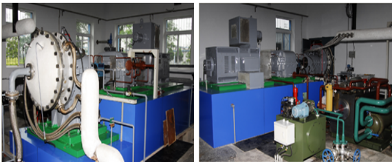
图 5 刷式密封实验装置实物图 Fig. 5 Actual drawing of brush seal experimental device
