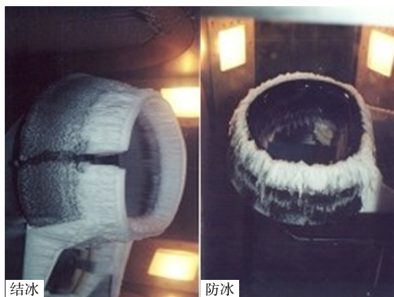
(a) 温度为 -20\text{ }^{\circ}\text{C} , 液态水含量为 0.55\text{ g/m}^3
