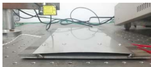
图 15 实验中变形蒙皮回复为平直状态
