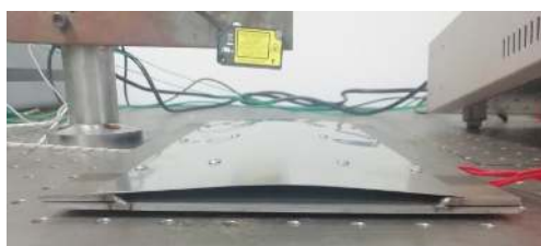
图 17 变形蒙皮回复为弯曲状态
