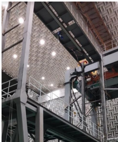
图 2 航空工业气动院风洞自由飞试验系统
