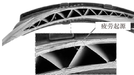
图 13 三层板超塑性成形/扩散连接叶片失效示意图 [77]
