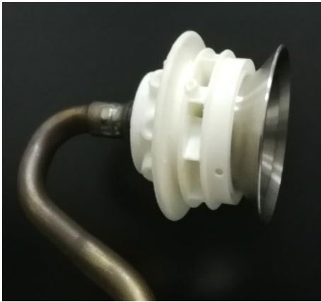
图 4 点火助燃头部安装照片
