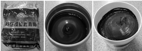
(a) 普通锂基 润滑脂 (b) 二硫化钼 润滑脂 (c) 高温石墨 润滑脂
