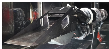
图3 进气道试验模型照片
