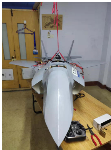
图 1 矢量喷管-升力风扇飞行器模型
