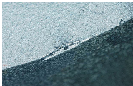
图 8 大梁断口源区宏观形貌
