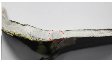
图 7 疲劳裂纹起源
