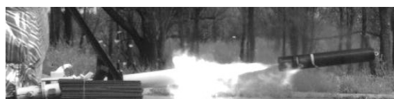
(c) 火箭弹飞离发射筒
