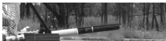
(b) 火箭弹尾部离开发射筒
