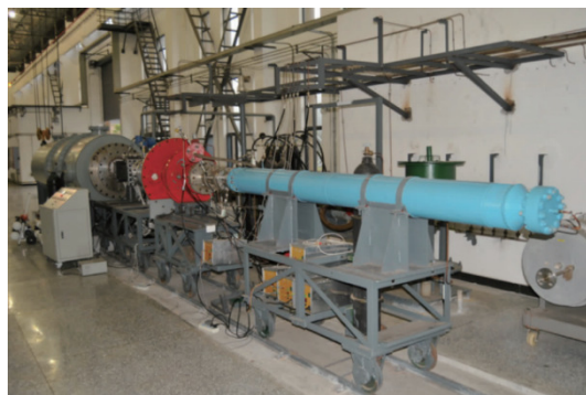
图 1 直连式脉冲燃烧风洞 [10]
