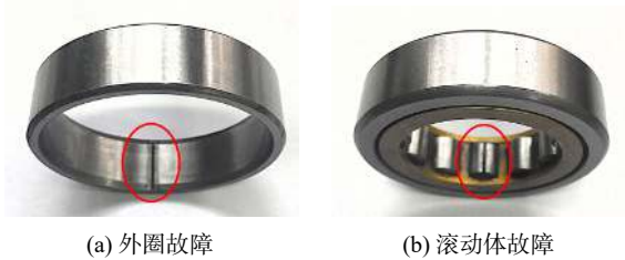
图 19 线切割加工的不同故障滚棒轴承照片
