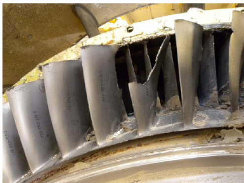
图 1 增压级叶片折断
