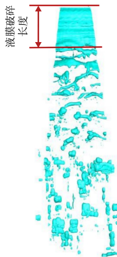
图 19 液膜破碎长度的定义
