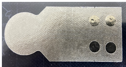
图 14 高温测量用的云母探头
