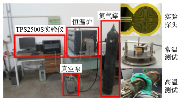
图 1 Hot-Disk 测试装置
