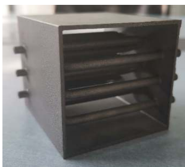
(b) S型管束管壳式换热器芯体
