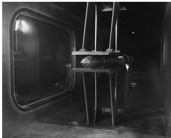
图 7 抑制装置和模型在风洞内的安装照片
