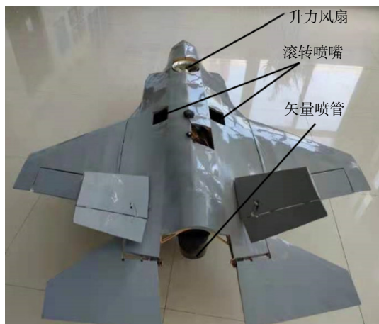
图 1 F-35B 缩比模型图
