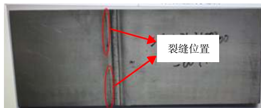
图 4 试验件疲劳裂纹位置
