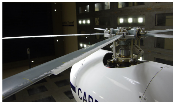
图4 桨尖结冰脱落 [17]
