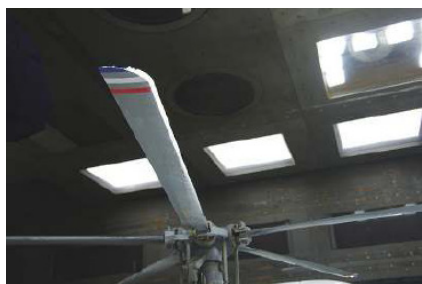
图3 旋翼桨叶结冰试验结果 [18]
