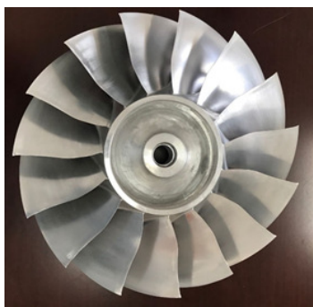
图2 整体叶盘试验件 Fig. 2 Blisk test piece
