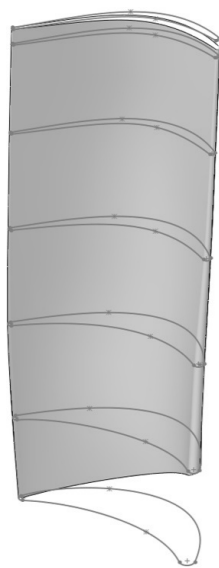
图11 CMCs 涡轮叶片叶身模型
