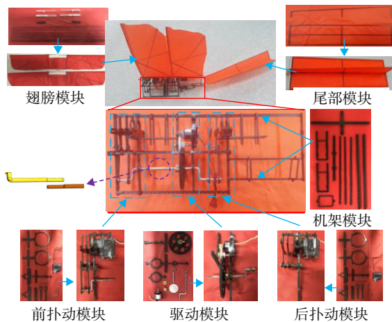
图6 模块化组装的碳纤维板扑翼样机
