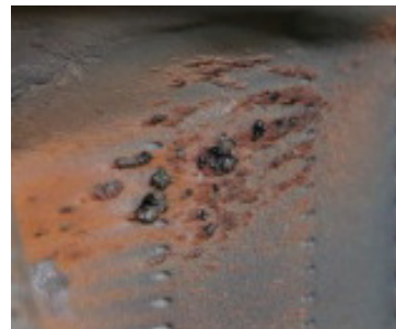
图 8 燃气涡轮一级导向器熔砂黏附 [21]
