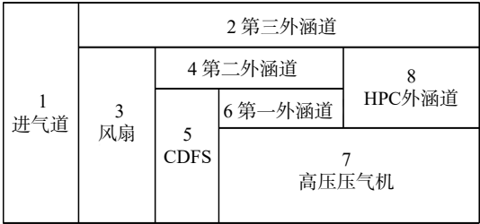
图 13 多涵道压缩系统的通流计算模型 Fig. 13 Throughflow calculation model of the multi-channel compression system
