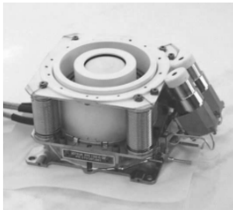
图 5 法国 SNECMA 公司 PPS-1350 霍尔推力器
