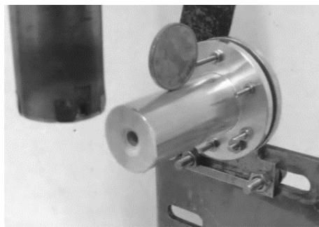
图 10 微牛级会切型霍尔推力器试验样机
