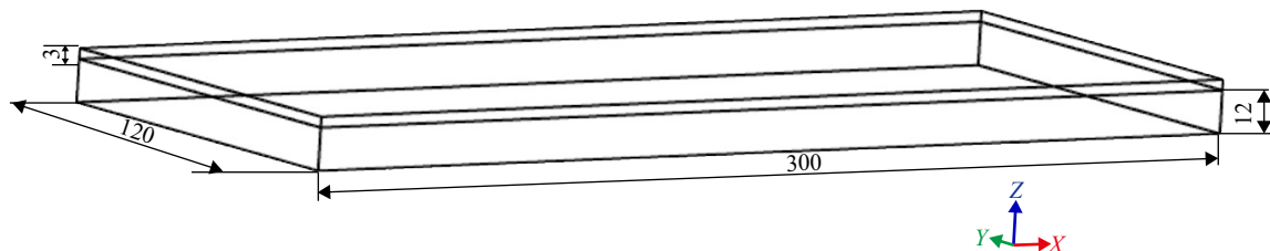
图 2 带热障涂层的叶片导热对流模型(单位: mm)
