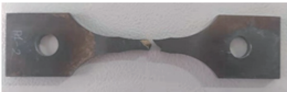
图 12 盘心应力梯度模拟件试验结果 Fig. 12 Test results of disc center hole stress gradient simulator
