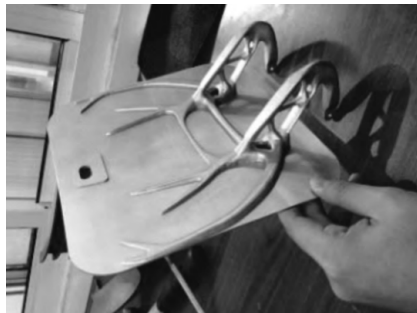
图 14 拓扑优化后增材制造航空发动机泄压门铰链 [73]
