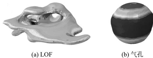
图 2 电弧增材制造成形 Al-Mg4.5Mn 铝合金缺陷形貌 [27]
