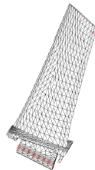
图 19 Laxalde 等 [33] 采用的含叶根榫头阻尼的叶片有限元模型
