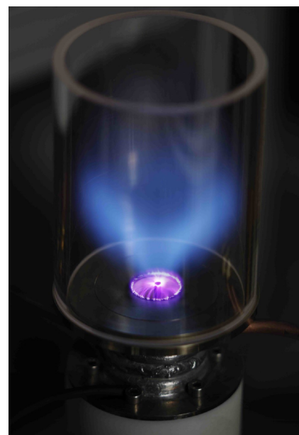
图 4 贫油预混 CH_4 -空气旋流火焰(蓝色)和纳秒脉冲放电(紫色)图片 [29]
